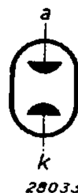
Abb. 1 Elektrodenanordnung der Neon-Stabilisierungsröhren.
